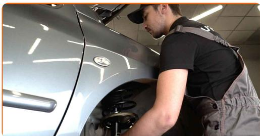
Remplacement : jambe de suspension – PEUGEOT 307 3/5 portes (3A/C). Les professionnels recommandent :
