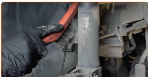
**22** Dévissez la fixation reliant la biellette à l'amortisseur. Utilisez une clé mixte de No.16 Utilisez une douille n° 15. Utilisez une clé à cliquet.
