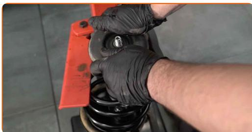
**46** Serrez l'écrou de l'entretoise d'amortisseur due la tige de piston. Utilisez une douille n° 18. Utilisez la clé HEX n° H7. Utilisez une clé dynamométrique. Serrez-le jusqu'à 69 Nm.
