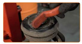
Retirez l'écrou de la tige de piston de l'entretoise. Utilisez la clé HEX n° H7. Utilisez une douille n° 18. Utilisez une clé à cliquet.
