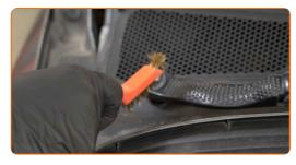
Dévissez les fixations des bras d'essuie-glaces. Utilisez une douille n° 16. Utilisez une clé à cliquet.
