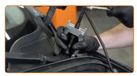
Dévissez les deux fixations du réservoir à liquide de frein. Utilisez la mèche Torx T20. Utilisez une clé à cliquet.
