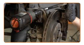
Retirez l'écrou de fixation.
