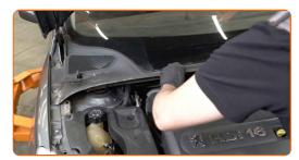
Serrez les fixations du cache d'auvent. Utilisez une douille n° 10. Utilisez une clé à cliquet.
