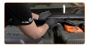
Serrez les deux fixations du réservoir de liquide de frein. Utilisez la mèche Torx T20. Utilisez une clé à cliquet.
