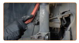
Dévissez la fixation reliant la biellette à l'amortisseur. Utilisez une clé mixte de No.16 Utilisez une douille n° 15. Utilisez une clé à cliquet.
