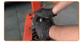
Serrez l'écrou de l'entretoise d'amortisseur due la tige de piston. Utilisez une douille n° 18. Utilisez la clé HEX n° H7. Utilisez une clé dynamométrique. Serrez-le jusqu'à 69 Nm.
