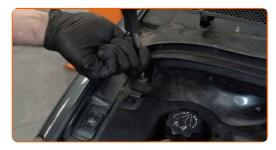
74 Installez les fixations sur le cache d'auvent.
