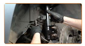
Serrez la fixation reliant la biellette à l'amortisseur. Utilisez une douille n° 15. Utilisez une clé dynamométrique. Serrez-le jusqu'à 36 Nm.
