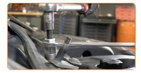
Lubrifiez les fixations de la coupelle d'amortisseur. Utilisez de la graisse au cuivre.
