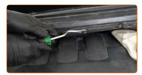
Dévissez les fixations du cache d'auvent. Utilisez une douille n° 10. Utilisez une clé à cliquet.
