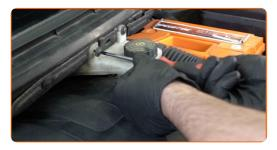
Retirez les clips de la grille d'auvent en plastique. Utilisez un outil d'extraction de clips.
