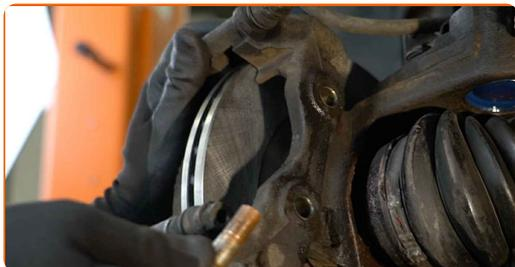
**28** Installez les boulons de fixation.
