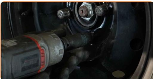
**40** Abaissez la voiture et serrez les boulons de roue en ordre croisé. Servez-vous d'une douille à choc pour roue N°19. Utilisez une clé dynamométrique. Serrez-le jusqu'à 90 Nm.
