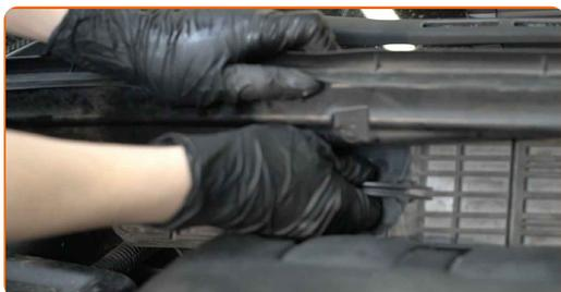
**4** Retirez l'élément filtrant du compartiment du filtre.
