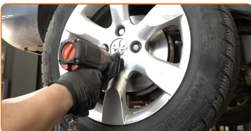
**33** Abaissez la voiture et serrez les boulons de roue en ordre croisé. Servez-vous d'une douille à choc pour roue N°17. Utilisez une clé dynamométrique. Serrez-le jusqu'à 100 Nm.
