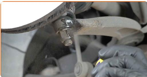
**11** Dévissez les fixations qui lient le joint à rotule au bras de contrôle de suspension. Utilisez une douille n° 21. Utilisez un porte-taraud.
