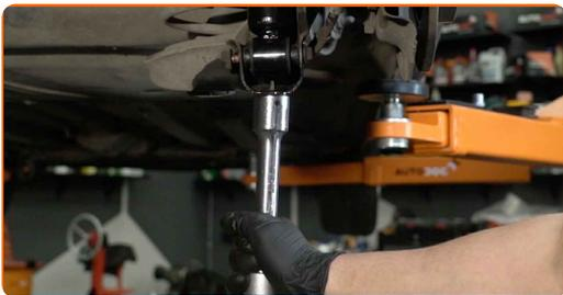
**26** Serrez l'attache inférieure de l'amortisseur. Utilisez une clé mixte de No.13 Utilisez une douille n° 15. Utilisez une clé dynamométrique. Serrez-le jusqu'à 57 Nm.
