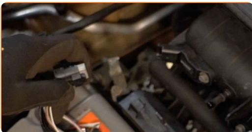
**10** Recouvrez le trou de la valve PCV avec un chiffon en microfibre pour empêcher la pénétration de poussière et de corps étrangers dans le système.
