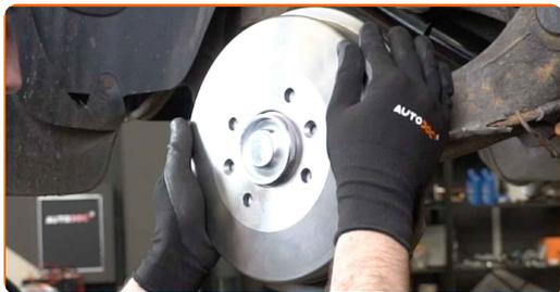
**16** Installez les boulons de fixation.
