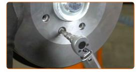
Appliquez du produit sur la surface de contact entre la jante et le tambour de frein. Utilisez du lubrifiant céramique.
