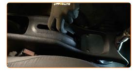
Desserrez l'écrou de réglage du câble du frein de stationnement. Utilisez une douille n° 12. Utilisez une clé à cliquet.
