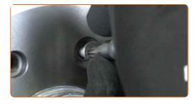
Serrez les fixations du tambour de frein. Utilisez la mèche Torx T30. Utilisez une clé dynamométrique. Serrez-le jusqu'à 10 Nm.
