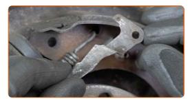
Desserrez le dispositif de réglage de la mâchoire de frein. Utilisez un tournevis plat.
