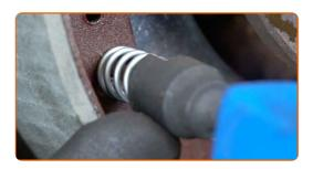
Installez le dispositif de réglage des mâchoires de frein.
