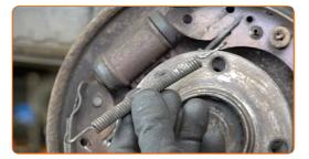
Retirez les éléments de retenue des mâchoires de frein à tambour. Utilisez un compresseur de ressort de frein.
