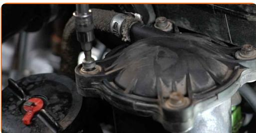
**5** Retirez le couvercle du boîtier du filtre à carburant.
