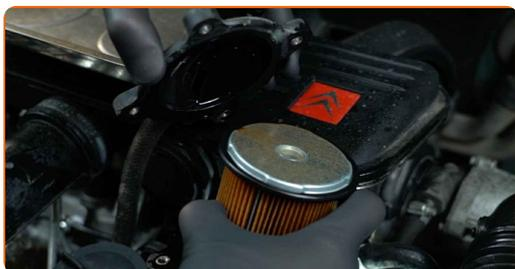
Remplacement : filtre à carburant – PEUGEOT 406 Break. AUTODOC recommande :
