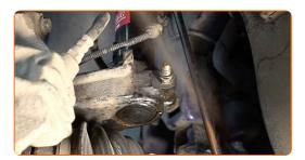
Appliquez du produit sur la zone de contact entre le disque de frein et la jante. Utilisez du lubrifiant céramique à haute température.
