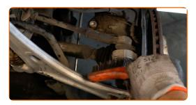
Dévissez l'écrou d'attache d'extrémité à la fusée d'essieu. Utilisez une douille n° 17. Utilisez une clé à cliquet.
