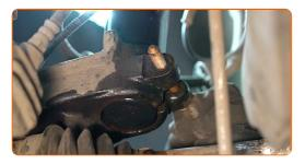
Serrez les fixations inférieures de la jambe de suspension. Utilisez une douille n° 16. Utilisez une clé dynamométrique. Serrez-le jusqu'à 55 Nm.
