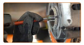
Nettoyez la fixation inférieure reliant la jambe de suspension à la fusée d'essieu. Utilisez une brosse métallique. Servez vous de l'aérosol WD-40.
