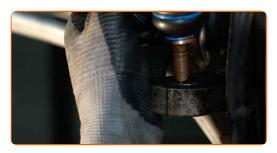
Serrez l'écrou de fixation reliant l'embout de biellette de direction à la fusée d'essieu. Utilisez une douille n° 17. Utilisez une clé dynamométrique. Serrez-le jusqu'à 35 Nm.
