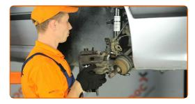
51 Installez l'écrou de fixation.
