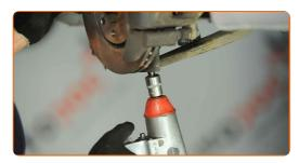
57 Installez l'écrou de fixation.
