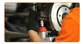
Appliquez du produit sur les fixations de l'amortisseur. Appliquez du produit sur la fixation reliant l'embout de biellette de direction à la fusée d'essieu. Appliquez du produit sur tous les joints du stabilisateur. Επεξεργαστείτε το στοιχείο στερέωσης στο μπαλάκι. Utilisez de la graisse au cuivre.
