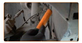
Dévissez la fixation inférieure assurant la connexion entre la jambe d'amortisseur et le porte-fusée. Utilisez une douille n° 16. Utilisez une clé à cliquet.
