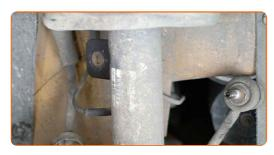
Dévissez le support de câble ABS. Utilisez une douille n° 10. Utilisez une clé à cliquet.
