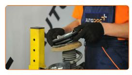
Serrez l'écrou de l'entretoise d'amortisseur due la tige de piston. Utilisez une clé mixte de No.21. Utilisez la clé HEX n° H6. Utilisez une clé dynamométrique. Serrez-le jusqu'à 65 Nm.
