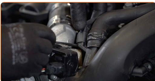
**3.2** Pressez l'anneau de serrage avec des pinces universelles et débranchez le tuyau de la valve à vide.
