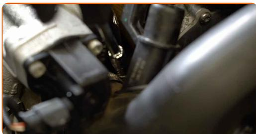
5 Détendez les anneaux de fixation qui relient le tuyau d'air au boîtier du filtre à air et au compresseur. Utilisez une clé mixte de No.7
