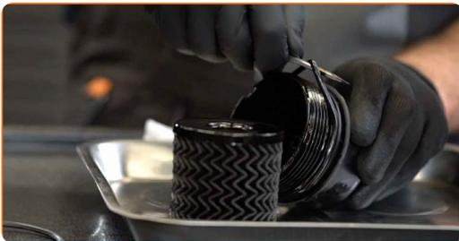
24 Installez une nouvelle bague d'étanchéité sur l'emplacement du filtre à huile.
