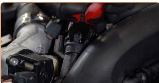
4 Dévissez les anneaux de serrage et débranchez le tuyau du compresseur d'alimentation du boîtier du filtre à air.
