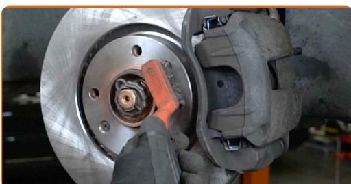
**92** Appliquez du produit sur la zone de contact entre le disque de frein et la jante. Utilisez de la graisse au cuivre.
