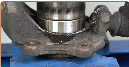
Remplacement : roulement de roue – PEUGEOT 408 Berline. AUTODOC recommande :
