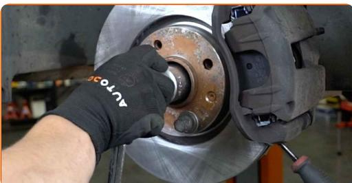
8 Retirez l'écrou de fixation.
