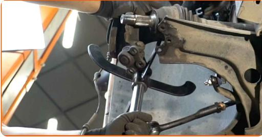
58 Installez l'écrou de fixation.
