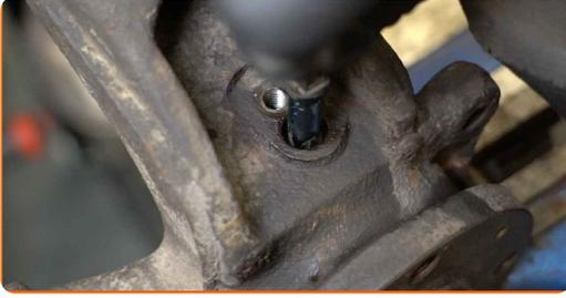
53 Vissez la fixation reliant le capteur ABS à la fusée d'essieu. Utilisez une douille n° 13. Utilisez une clé dynamométrique. Serrez-le jusqu'à 10 Nm.
