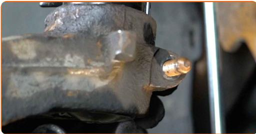
59 Vissez la fixation qui relie la jambe d'amortisseur à la fusée d'essieu. Utilisez une douille n° 16. Utilisez une clé à cliquet.
