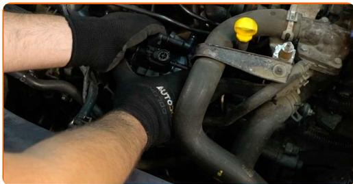
**17** Attachez le connecteur du capteur de pression du carburant.
