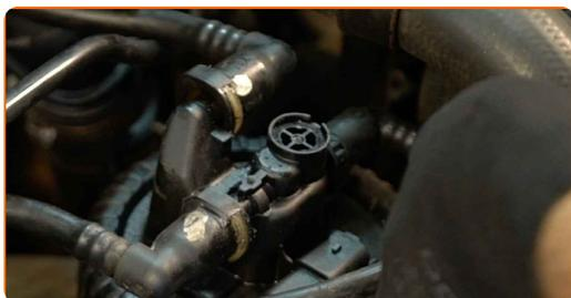
**18** Connectez les lignes d'alimentation en carburant au filtre à carburant.
