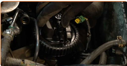
**16** Serrez les attaches du filtre à carburant.
