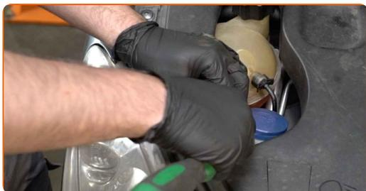
**4** Retirez le bouchon du réservoir de liquide de refroidissement.
