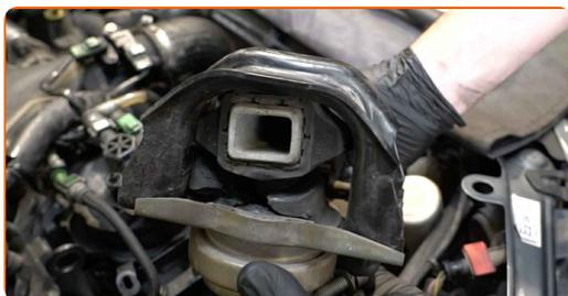
Remplacement : support moteur – PEUGEOT EXPERT Camion plate-forme/Châssis. AUTODOC recommande :
