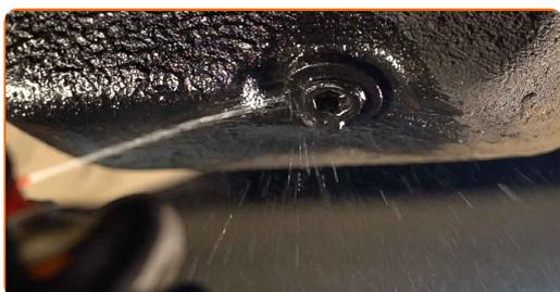
**7** Placez un contenant d'huile de vidange d'une capacité de 5 l minimum sous l'orifice de drainage.
