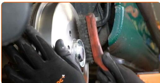
**21** Appliquez du produit sur la surface de contact entre la jante et le tambour de frein. Utilisez du lubrifiant céramique.
