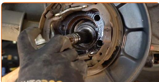
**21** Installez le nouveau moyeu de roue avec le roulement.
