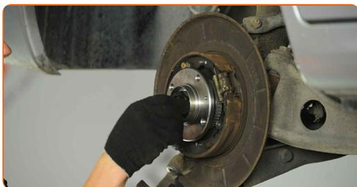
**23** Serrez le moyeu. Utilisez une douille n° 41. Utilisez une clé dynamométrique. Serrez-le jusqu'à 275 Nm.
