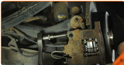
**31.2** Utilisez une douille n° 16. Utilisez une clé dynamométrique. Respecter bien le couple de serrage recommandé.
