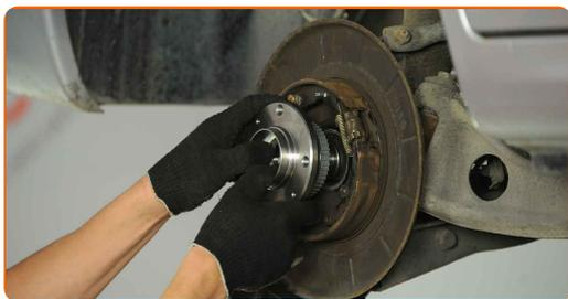
**22** Installez l'écrou de fixation.
