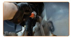
Dévissez la fixation reliant la biellette à la barre stabilisatrice. Utilisez une douille n° 16. Utilisez une clé à cliquet.
