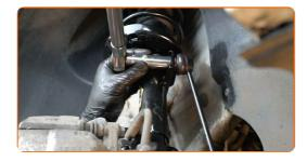
Serrez la fixation reliant la biellette à la barre stabilisatrice. Utilisez une douille n° 17. Utilisez une clé dynamométrique. Serrez-le jusqu'à 40 Nm.
