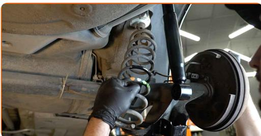
Remplacement : ressort de suspension – VW Polo 5. AUTODOC recommande :
