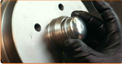
23 Appliquez du produit sur la surface de contact entre la jante et le tambour de frein. Utilisez de la graisse au cuivre.
