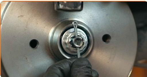
22 Installez le bouchon de l'écrou du moyeu. Servez-vous d'un marteau.
