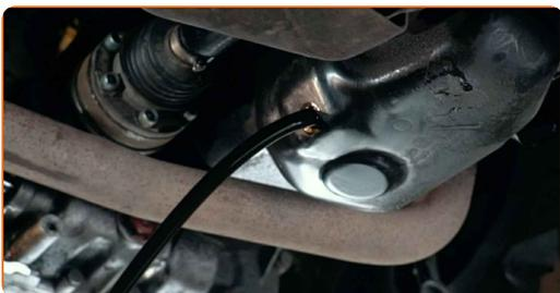
Remplacement : huile moteur et filtre à huile – VW Polo 6N1. AUTODOC recommande :
