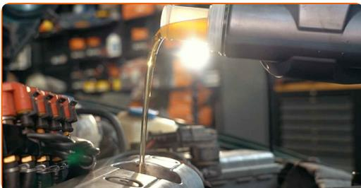
Remplacement : huile moteur et filtre à huile – VW Polo 6N1. Les professionnels recommandent :
