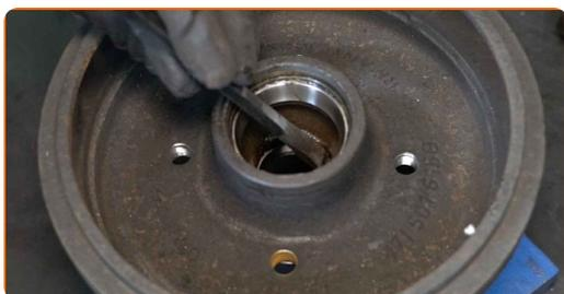
**16** Retirez la bague intérieure du roulement de roue du tambour de frein. Servez-vous d'un burin plat pour l'usinage des métaux. Servez-vous d'un marteau.
