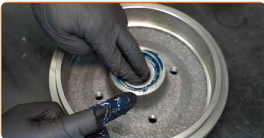
**23** Installez l'anneau de retenue du palier du moyeu de roue. Servez-vous d'un coffret de douilles et de roulements. Servez-vous d'un marteau.
