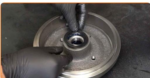
**24** Appliquez du produit sur la bague intérieure et sur le roulement de roue. Servez-vous d'une graisse multi-usages.
