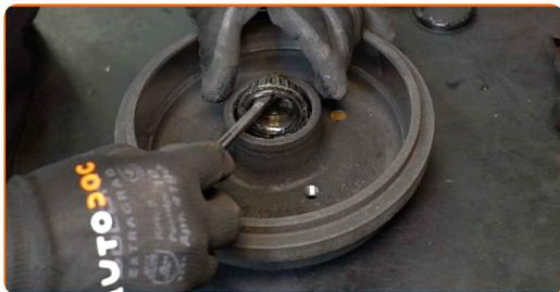
**14** Nettoyez l'emplacement de roulement de moyeu.
