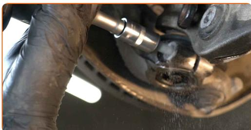
**15** Retirez l'écrou de fixation.
