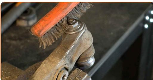
**19** Dévissez les fixations qui lient le joint à rotule au bras de contrôle de suspension. Utilisez une douille n° 21. Utilisez une clé à cliquet.
