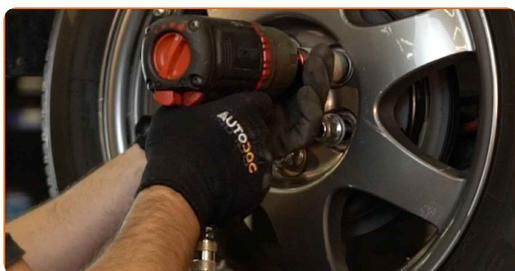
**24** Abaissez la voiture et serrez les boulons de roue en ordre croisé. Utilisez une clé dynamométrique. Serrez-les jusqu'à 103 Nm.
