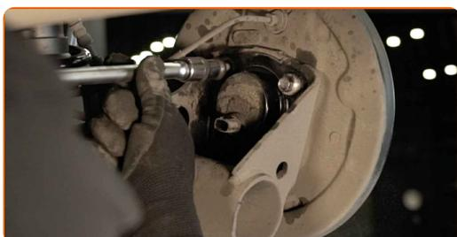
**12** Retirez le moyeu et le roulement puisqu'ils forment un bloc hermétique.
