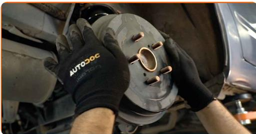
**21** Appliquez du produit sur la surface de contact entre la jante et le tambour de frein. Utilisez de la graisse au cuivre.
