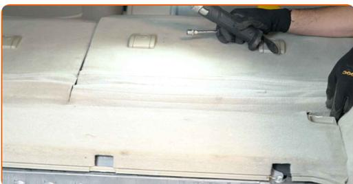
**61** Vissez la fixation du panneau central de protection en plastique. Utilisez une douille n° 10. Utilisez une clé à cliquet.
