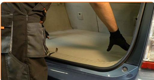
**66** Installez les attaches de la garniture avant inférieure du coffre.
