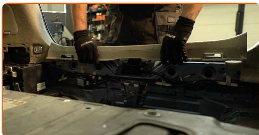
**15** Dévissez la fixation et retirez l'isolation sonore latérale du coffre. Utilisez une douille n° 10. Utilisez une clé à cliquet.
