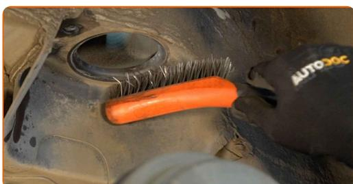
**44** Appliquez du produit sur les emplacements de montage de la jambe d'amortisseur. Utilisez de la graisse au cuivre.
