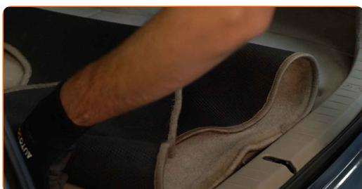
**4** Retirez les attaches de la garniture avant inférieure du coffre. Utilisez un outil d'extraction de clips.
