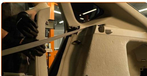
**13** Dévissez les fixations de la garniture latérale en plastique. Utilisez une douille n° 10. Utilisez une clé à cliquet.
