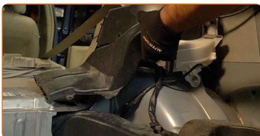
**17** Dévissez la fixation supérieure du support d'amortisseur. Utilisez une douille n° 14. Utilisez une clé à cliquet.
