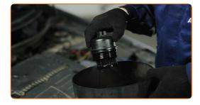
Retirez la bague d'étanchéité du boitier du filtre à huile. Utilisez un tournevis plat.
