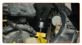
Utilisez une douille n° 27. Utilisez une clé dynamométrique. Serrez-le jusqu'à 25 Nm.
