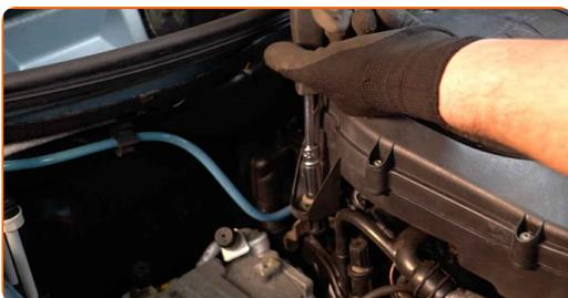
14 Installez le ressort de retenue du boîtier du filtre à air.
