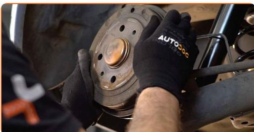
**18** Serrez les fixations des tambours de frein. Utilisez une douille n° 12. Utilisez une clé dynamométrique. Serrez-le jusqu'à 15 Nm.
