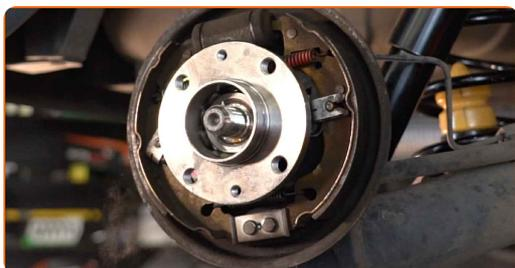
**14** Serrez le moyeu. Utilisez une douille n° 32. Utilisez une clé dynamométrique. Serrez-le jusqu'à 280 Nm.
