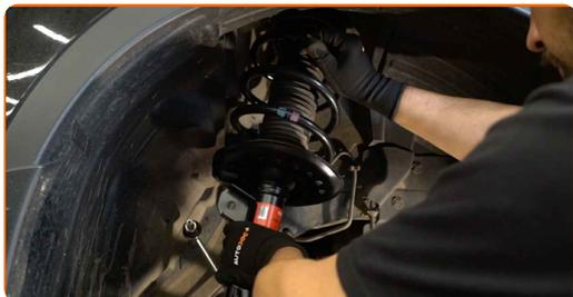
**48** Vissez l'attache supérieure du support de l'amortisseur. Ne serrez pas trop.
