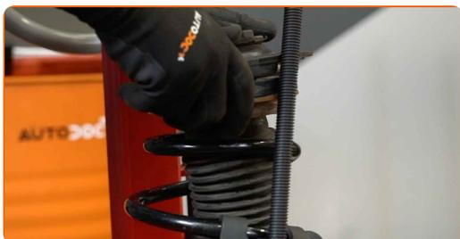
**42** Serrez l'écrou de l'entretoise d'amortisseur due la tige de piston. Utilisez la clé HEX n° H6. Utilisez une douille n° 18. Utilisez une clé dynamométrique. Serrez-le jusqu'à 62 Nm.
