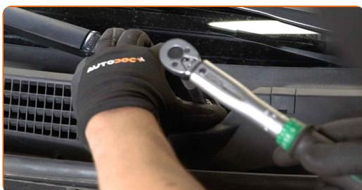
**76** Appliquez du produit sur les fixations des bras d'essuie-glace. Utilisez de la graisse au cuivre.
