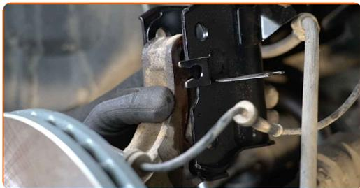
**52** Installez les boulons de fixation.
