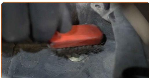
**10** Dévissez la fixation supérieure du support d'amortisseur. Utilisez une douille n° 13. Utilisez une clé à cliquet.
