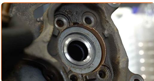
**38** Vissez l'écrou de l'axe de moyeu de roue. Utilisez une douille n° 17. Utilisez une clé à cliquet.
