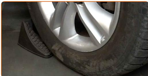
**2** Desserrez les boulons de fixation de la roue. Servez-vous d'une douille à choc pour roue N°21.
