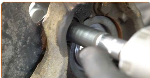
**39** Serrez le moyeu. Utilisez une douille n° 17. Utilisez une clé dynamométrique. Serrez-le jusqu'à 70 Nm.
