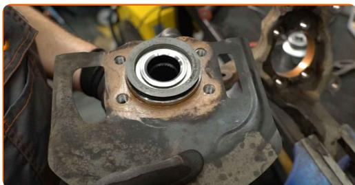
**37** Installez le nouveau moyeu de roue avec un roulement.
