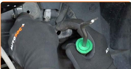
**19** Détachez le connecteur du capteur ABS. Utilisez un outil d'extraction de clips.
