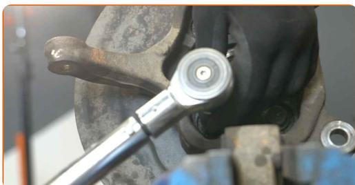
**40** Appliquez du produit sur la fixation du capteur ABS. Servez-vous d'une graisse multi-usages.
