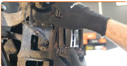
**22** Serrez le support de l'étrier de frein. Utilisez une douille n° 17. Utilisez une clé dynamométrique. Serrez-le jusqu'à 84 Nm.
