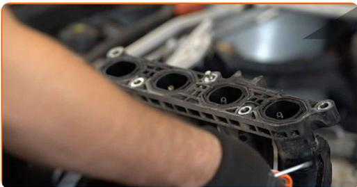
**25** Retirez le joint d'étanchéité du collecteur d'admission. Utilisez un tournevis plat.
