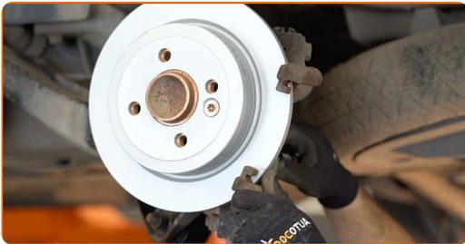
**22** Serrez le support de l'étrier de frein. Utilisez une douille n° 16. Utilisez une clé dynamométrique. Serrez-le jusqu'à 65 Nm.
