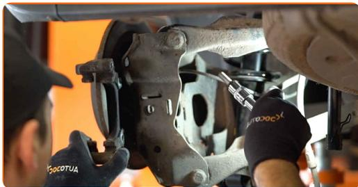
16 Dévissez les boulons de montage du disque de frein et retirez-les. Utilisez la mèche Torx T30.
