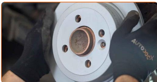
19 Serrez l'attache du disque de frein. Utilisez la mèche Torx T30. Utilisez une clé dynamométrique. Serrez-le jusqu'à 9 Nm.
