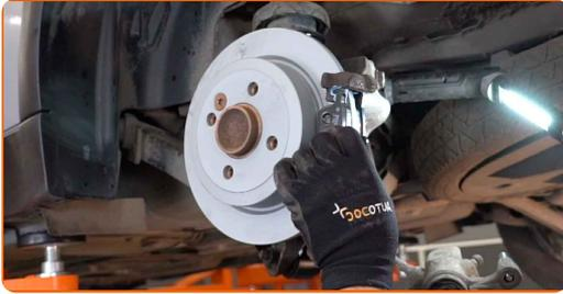
25 Installez l'étrier de frein et fixez-le. Utilisez la clé HEX n° H7. Utilisez une clé dynamométrique. Serrez-le jusqu'à 30 Nm.
