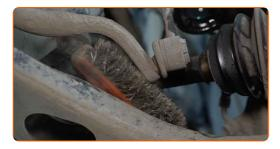
Dévissez la fixation reliant la biellette à la barre stabilisatrice. Utilisez une douille n° 14. Utilisez une clé à cliquet.
