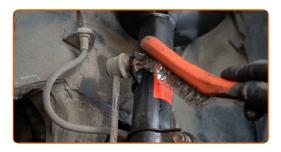
Dévissez la fixation reliant la biellette à l'amortisseur. Utilisez une douille n° 14. Utilisez une clé à cliquet.
