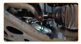
Serrez la fixation reliant la biellette à l'amortisseur. Utilisez une douille n° 14. Utilisez une clé dynamométrique. Serrez-le jusqu'à 44 Nm.
