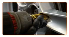
Abaissez la voiture et serrez les boulons de roue en ordre croisé. Servez-vous d'une douille à choc pour roue N°19. Utilisez une clé dynamométrique. Serrez-le jusqu'à 103 Nm.
