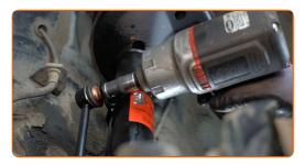
Serrez la fixation reliant la biellette à la barre stabilisatrice. Utilisez une douille n° 14. Utilisez une clé dynamométrique. Serrez-le jusqu'à 44 Nm.
