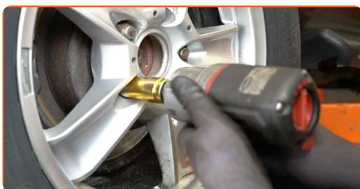
**32** Abaissez la voiture et serrez les boulons de roue en ordre croisé. Servez-vous d'une douille à choc pour roue N°19. Utilisez une clé dynamométrique. Serrez-le jusqu'à 103 Nm.
