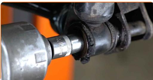
**12** Retirez l'écrou de fixation.
