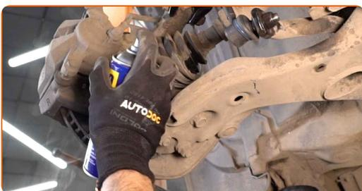
11 Dévissez l'attache du support d'étrier. Utilisez une douille n° 17. Utilisez un porte-taraud.
