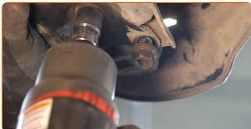
**34** Serrez l'attache du joint rotule. Utilisez une douille n° 17. Utilisez une clé dynamométrique. Serrez-le jusqu'à 92 Nm.
