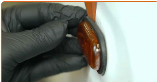
**2** Détachez la douille de l'ampoule du clignotant.
