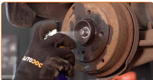
**9** Dévissez l'écrou de l'axe de moyeu de roue. Utilisez une douille n° 30. Utilisez un porte-taraud.
