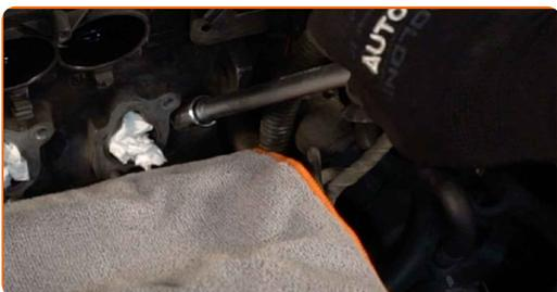
**19** Vissez les nouvelles bougies et serrez-les. Servez-vous de la douille de bougie d'allumage n°16. Utilisez une clé dynamométrique. Serrez-le jusqu'à 25 Nm.
