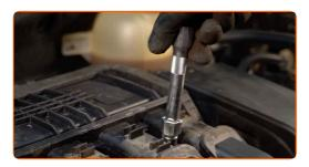
Vissez les nouvelles bougies et serrez-les. Servez-vous de la douille de bougie d'allumage n°16. Utilisez une clé dynamométrique. Serrez-le jusqu'à 28 Nm.
