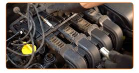
Appliquez une fine couche d'antigrippant à haute température sur les fils des nouvelles bougies d'allumage.
