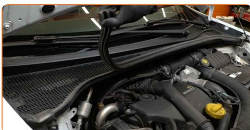
**4** Retirez les clips du cache d'auvent. Utilisez un outil d'extraction de clips.
