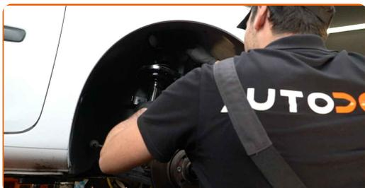
**49** Vissez l'attache supérieure du support de l'amortisseur. Ne serrez pas trop.
