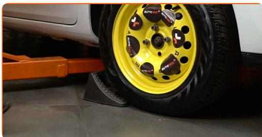
**11** Desserrez les boulons de fixation de la roue. Servez-vous d'une douille à choc pour roue N°17.
