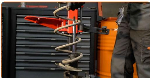
**37** Retirez l'amortisseur usagé du compresseur à ressort hydraulique hélicoïdal.
