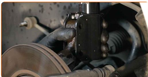
**52** Installez les boulons de fixation.
