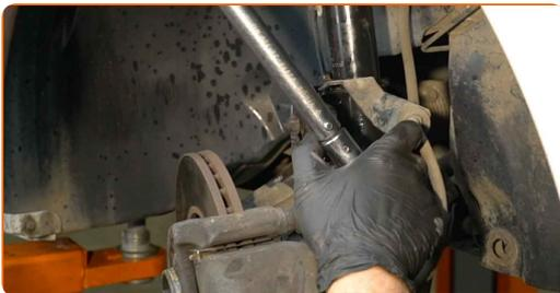
**61** Appliquez du produit sur les fixations de l'amortisseur. Utilisez de la graisse au cuivre.
