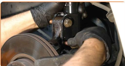
**45** Vissez la fixation qui relie la jambe d'amortisseur à la fusée d'essieu. Utilisez une clé mixte de No.18 Utilisez une douille n° 18. Utilisez une clé à cliquet.
