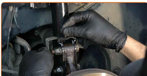
**48** Serrez le collier de serrage du flexible de frein de l'entretoise de l'amortisseur. Utilisez une douille n° 10. Utilisez une clé à cliquet.
