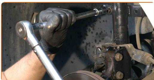
**52** Serrez les fixations inférieures qui relient l'amortisseur à la fusée d'essieu. Utilisez une clé mixte de No.18 Utilisez une douille n° 18. Utilisez une clé dynamométrique. Serrez-le jusqu'à 105 Nm.
