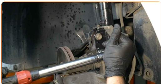
**53** Appliquez du produit sur les fixations de l'amortisseur. Utilisez de la graisse au cuivre.
