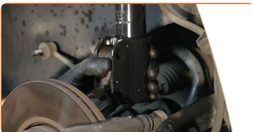
**44** Installez les boulons de fixation.
