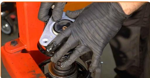
**35** Serrez l'écrou de l'entretoise d'amortisseur due la tige de piston. Utilisez une douille n° 18. Utilisez la clé HEX n° H6. Utilisez une clé dynamométrique. Serrez-le jusqu'à 62 Nm.
