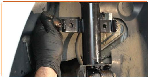
**51** Serrez la fixation reliant la biellette à l'amortisseur. Utilisez une douille n° 16. Utilisez une clé dynamométrique. Serrez-le jusqu'à 44 Nm.
