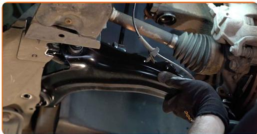
**30** Connectez le joint rotule à la fusée d'essieu.
