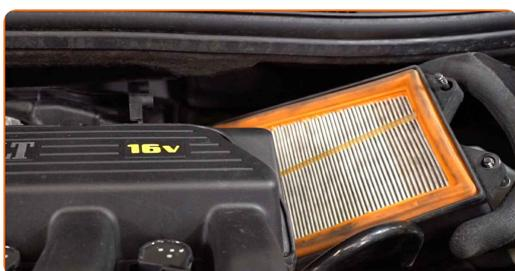
9 Retirez l'élément filtrant du compartiment du filtre.
