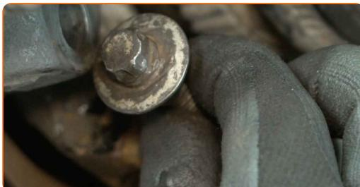
**30** Serrez le boulon qui relie le joint à rotule inférieur à la fusée d'essieu. Utilisez une clé mixte de 16 mm. Utilisez une douille Torx E16. Utilisez une clé dynamométrique. Couple de serrage : 70 N.m.
