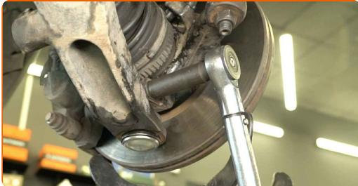
**31** Installez le boulon de fixation inférieur du support de l'étrier de frein.
