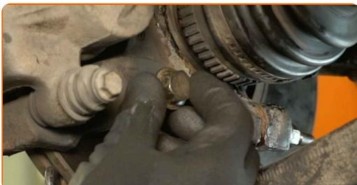
**32** Serrez la fixation inférieure du support de l'étrier de frein. Utilisez une douille de 18 mm. Utilisez une clé dynamométrique. Couple de serrage : 110 N·m.
