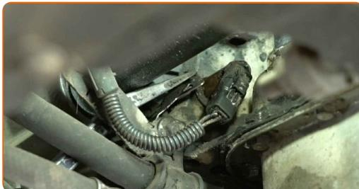
**3** Déposez le capteur de position du vilebrequin.
