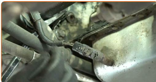
**4** Retirez le ressort de retenue du capteur de position du vilebrequin.
