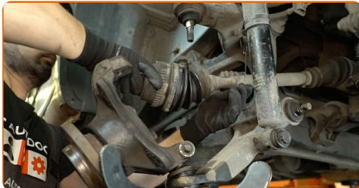
Remplacement : roulement de roue – RENAULT Master II Bus. Les professionnels recommandent :
