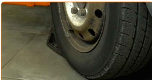
**2** Desserrez les fixations de la roue. Utilisez une douille à choc pour jantes de 24 mm. Utilisez une barre de force.
