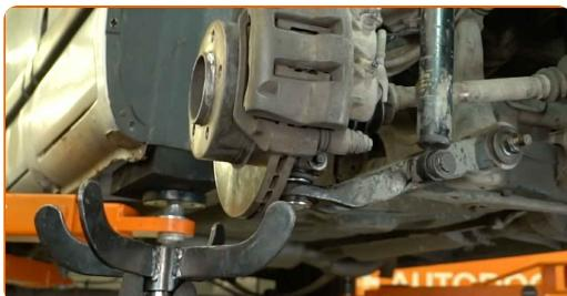
**Remplacement : rotule de suspension – RENAULT Master II Camion plate-forme/Châssis. Conseil des experts d'AUTODOC :**
