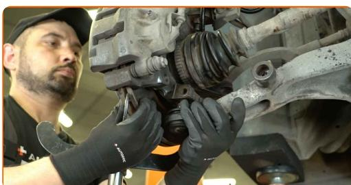
**Remplacement : rotule de suspension – RENAULT Master II Camion plate-forme/Châssis. Conseil :**
